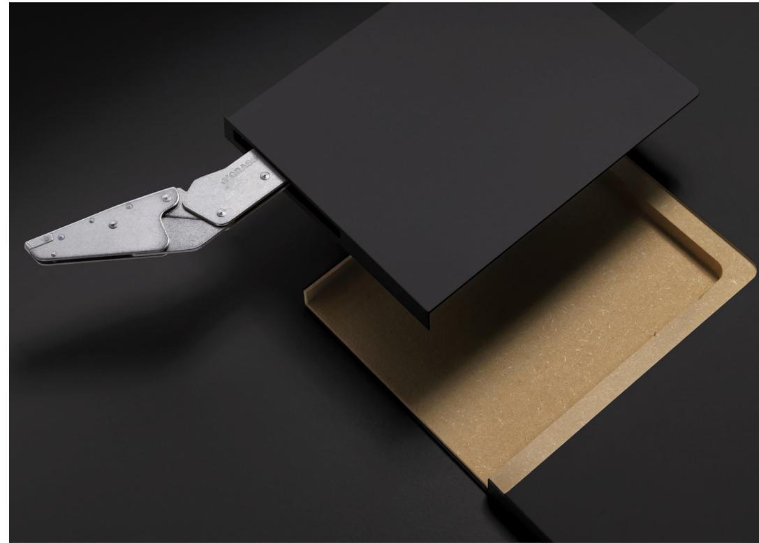
Fräsen. Beschlag einsetzen. Abdeckkappe aufklipsen. Fertig. So einfach kann Technik sein. Das korpusseitige Fräsbild für Kinvaro T-Slim misst gerade mal 12 x 155 x 185 mm und lässt sich bereits ab Korpusstärke 16 mm umsetzen.
