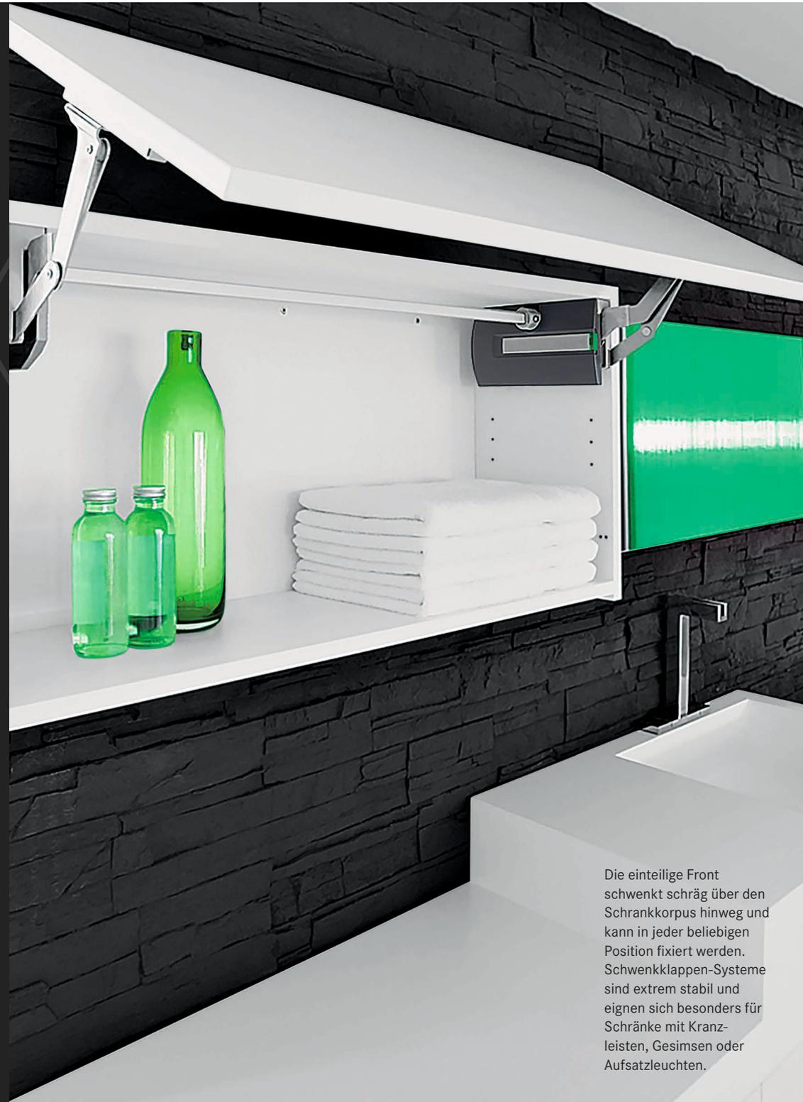
Die einteilige Front schwenkt schräg über den Schrankkorpus hinweg und kann in jeder beliebigen Position fixiert werden. Schwenklappen-Systeme sind extrem stabil und eignen sich besonders für Schränke mit Kranzleisten, Gesimsen oder Aufsatzleuchten.
